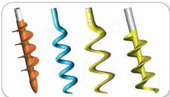
Die erste Form links zum „Sandbewegen“. In der Mitte die perfekten aber zu teuren ersten Prototypen und ganz rechts die endgültige Form aus Polypropylen.
